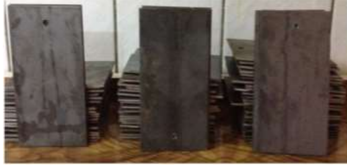
صورة (1) عينات الصلب الكربوني قبل التآكل
